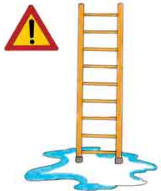
Fig. 24 - Appoggiare la scala su superfici non scivolose
