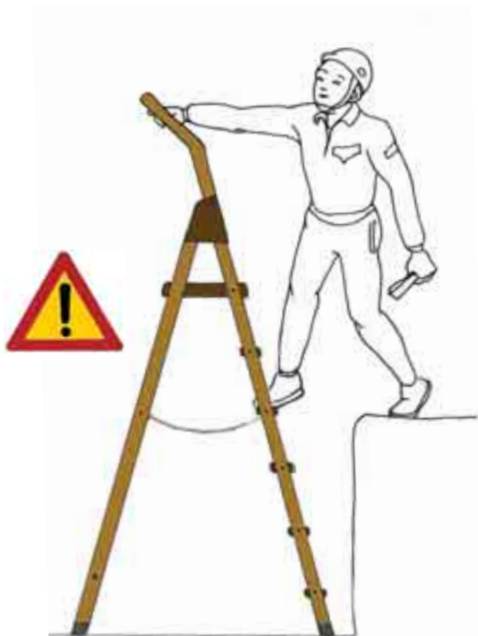
Fig. 10b - Posizionare entrambi i piedi sulla scala
