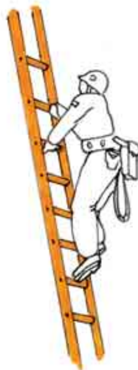
Fig. 41 - Corretta procedura di salita e discesa
